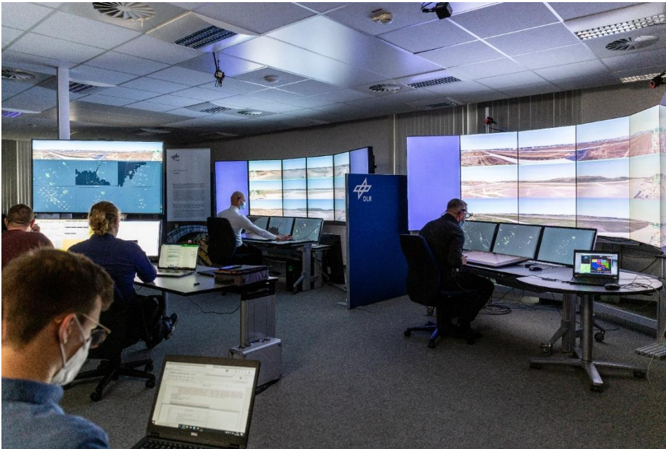
Ein Remote Control Center Prototyp wurde im Institut für Flugführung der DLR aufgebaut, um damit 15 simulierte Flughäfen möglichst realitätsnah aus der Ferne zu kontrollieren. © DLR
