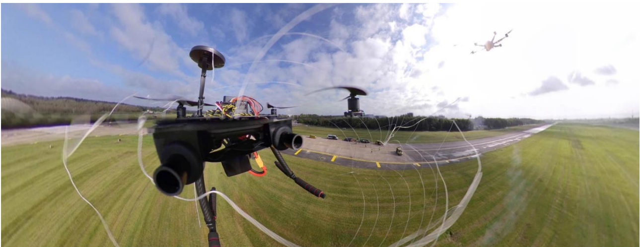
Feinddrohne wird im Flug von Fangnetz erfasst (© Frequentis)
